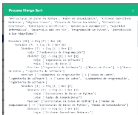
Figura 6. Ordenamiento mediante Merge Sort. Fuente: Elaboración propia.
